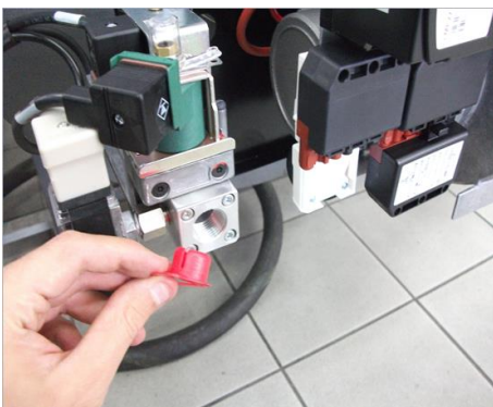
7 - Снять заглушку из Труба ГАЗОВОЙ рампы;
