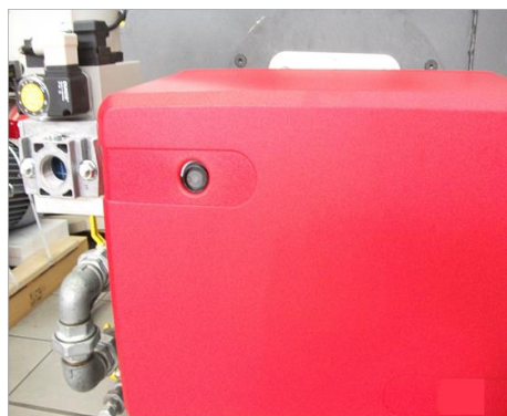
17 - Снять заглушку из электроклапан, Подключить газовую арматуру к газопроводу и Переустановите кожух
