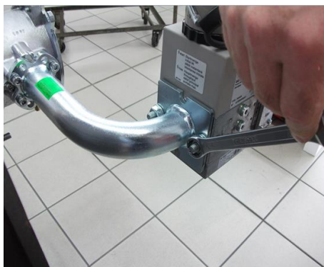
8 - установить электроклапан и Прикрепить из фланец;
