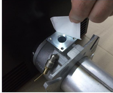
2 - повернуть Горелка и Снять заглушку;
