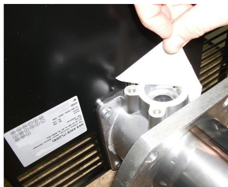
2 - повернуть Горелка и Снять заглушку;
