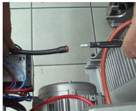
3 - Отсоединить кабель электрода ионизации от разъема;
