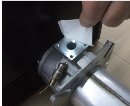
2 - повернуть Горелка и Снять заглушку;
