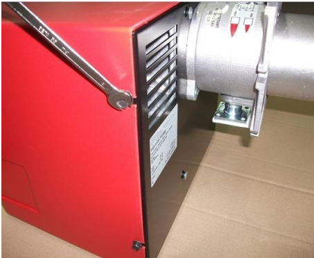
1 - Снять кожух, ослабив 4 винта;
