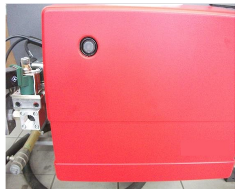
9 - Переустановите кожух и Подключить газовую арматуру к газопроводу
