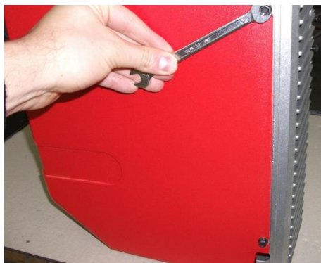
1 - Снять кожух, ослабьте 4 винта;
