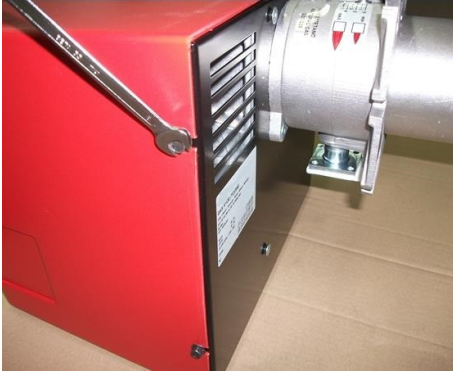
1 - Снять кожух, ослабив 4 винта;
