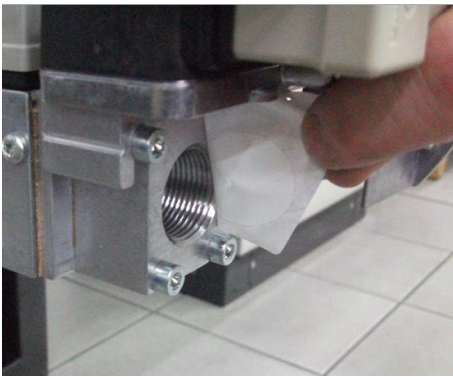
7 - Снять заглушку из Труба ГАЗОВОЙ рампы;
