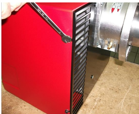
1 - Снять кожух, ослабив 4 винта;
