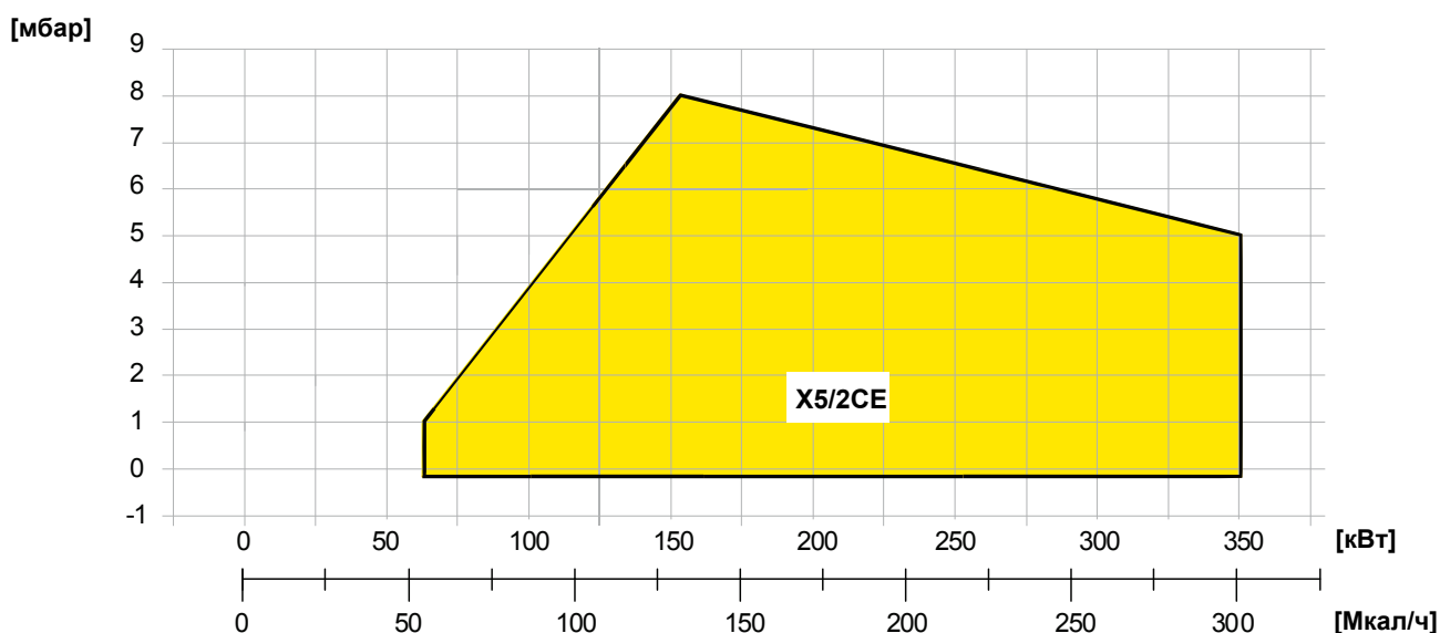
Fig. 3 X = Мощность Y = Сопротивление камеры сгорания
