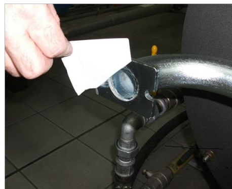
6 - Снять заглушку из Труба ГАЗОВОЙ рампы;
